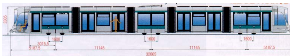
Rames Citadis du Nouveau Tramway de Lyon et de Paris (33 mètres de longueur, capacité de 213 personnes, à 4 P/m 2 )
