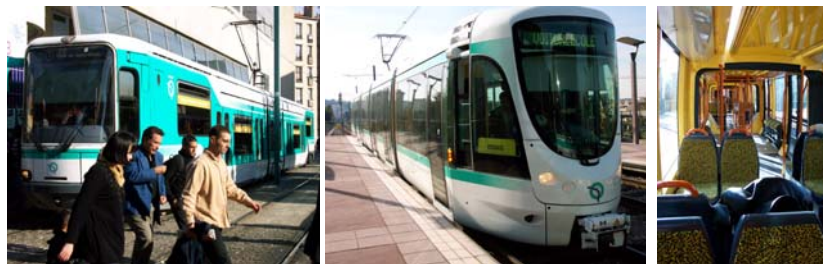
Paris (seconde génération : noter le système d'accouplement, à l'avant, permettant de composer des «trains» dont la capacité sera de 500 à 600 passagers)
